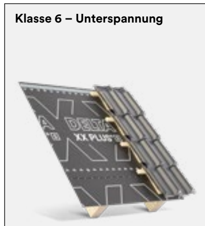
Klasse 6 – Unterspannung Unterspannbahnen werden freigespannt oder leicht durchhängend über die Sparren hinweg verlegt. Die Bahnen überdecken sich dabei lose um mindestens 10 cm.
