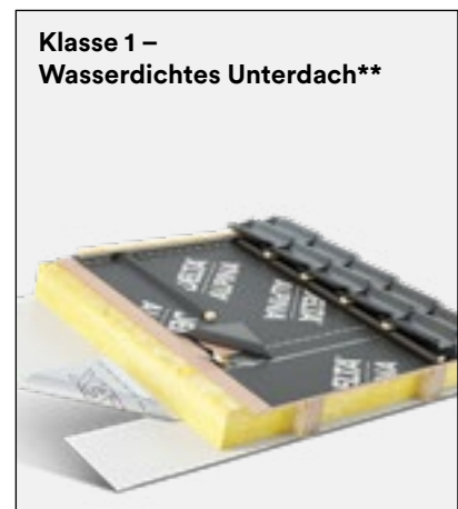
Klasse 1 – Wasserdichtes Unterdach** Kennzeichnend ist die Ausführung auf einem druckstabilen Untergrund (Dachschalung, druckstabile Aufdachdämmung o.Ä.) mit geeigneten Unterdeckbahnen (siehe Folgeseite), einschließlich Einbindung der Konterlattung. Anschlüsse an begrenzte Bauteile oder notwendige Durchdringungen sind wasserdicht auszuführen.
