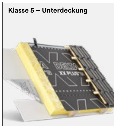
Klasse 5 – Unterdeckung Unterdeckbahnen liegen auf einem flächigen Untergrund (Schalung, Dämmung usw.) auf. Die Überdeckung erfolgt wie bei der Unterspannung mit einem Mindestmaß von 10 cm.
