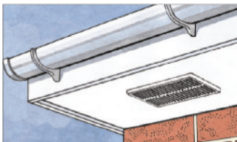
Рис. 7. Варианты вентиляции через подшивку карнизного свеса
