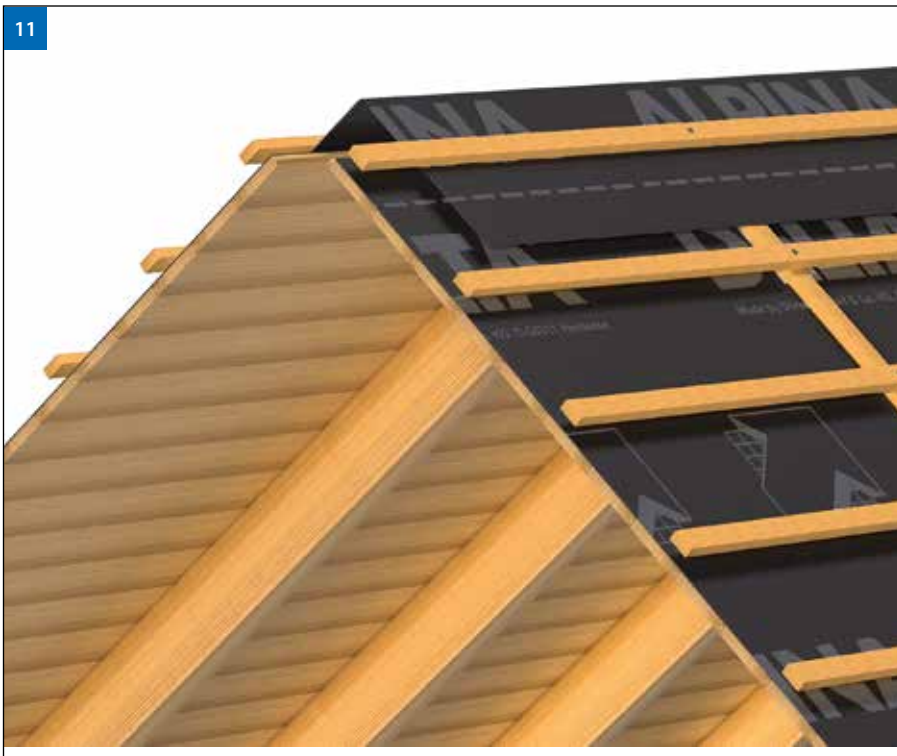
Конёк холодной крыши (Рис.11):
