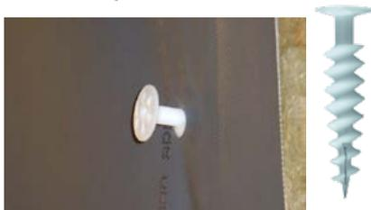
Cheville synthétique avec filetage hélicoïdal destinée à la fixation provisoire d'écrans pare-pluie dans différents matériaux isolants derrière des bardages rapportés. La fixation définitive est assurée par apposition d'un profilé verticale de maintien du pare-pluie (entraxe maxi : 645 mm). Carton de 50 vis.
